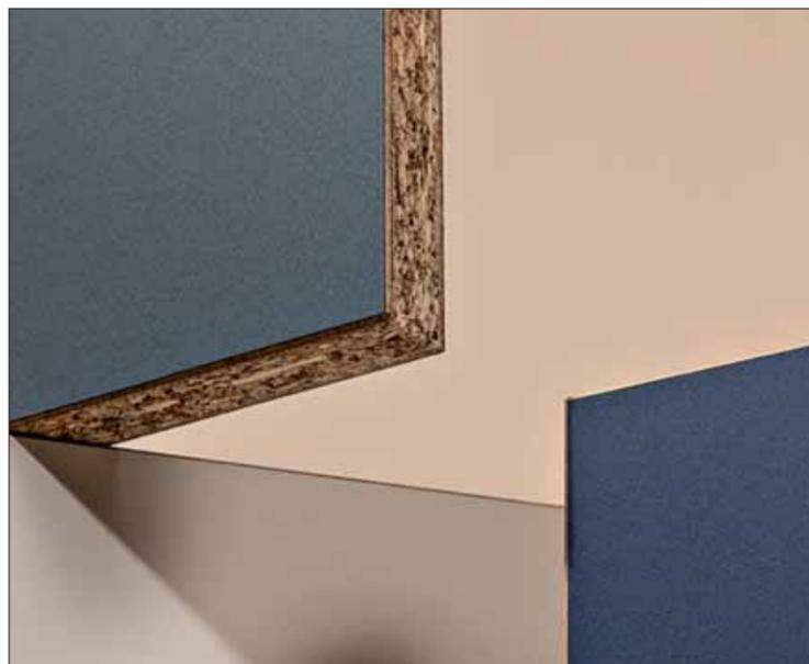
Zweilagig, aber in einem Prozess gefertigt: „Superpan“ von Finsa Foto: Finsa
